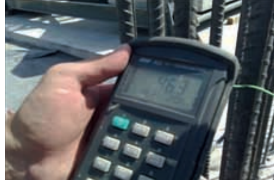
Şekil 1 Kablolu termometre cihazı
