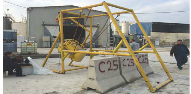
Şekil 6. Dinamik yer değiştirme ( D_m ), çalışma genişliği ( W_m ) ve taşıt girme mesafesi ( V_m ) ölçüm değerleri
