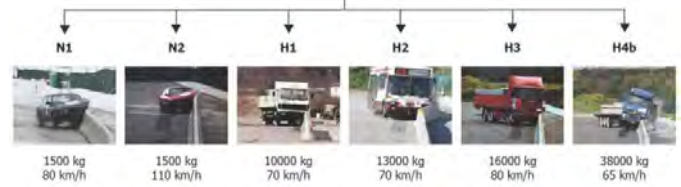
Şekil 3. Yolda tutma seviyelerine göre güvenlik bariyerleri sınıfları
