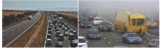
Şekil 12.a. Tek yönlü araç trafiği Şekil 12.b. Hareketli beton bariyer ile tek yönlü araç trafiği çözümü
