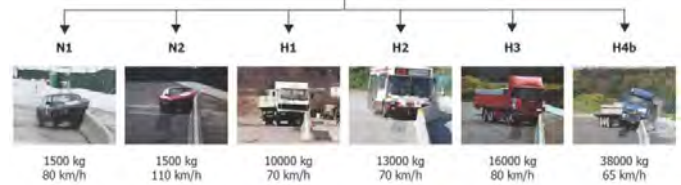
Şekil 3. Yolda tutma seviyelerine göre güvenlik bariyerleri sınıfları
