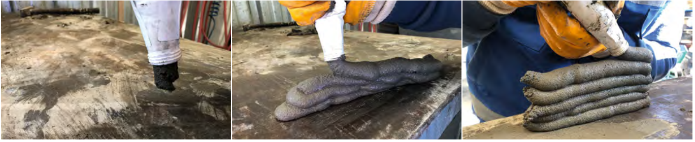
Şekil 1. SA/çimento ve su/çimento oranlarının işlenebilirliğe ve taşıtılabilirliğe etkisi
