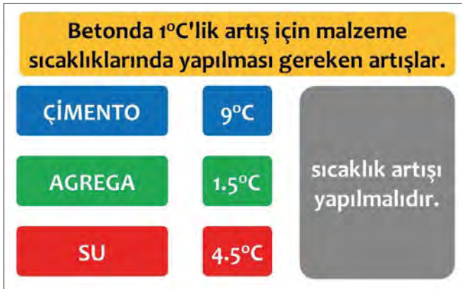
Şekil 6: Ham madde sıcaklık artışının beton sıcaklığına etkisi
