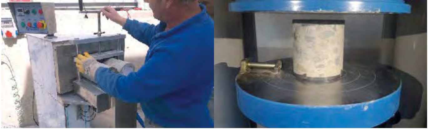
Şekil 4. Karot Numunesi Aşındırma, Başlıklama ve Kırım İşlemi
