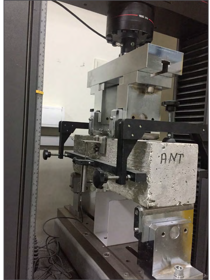
Şekil 3: ASTM C 1609 Test Düzeneği
