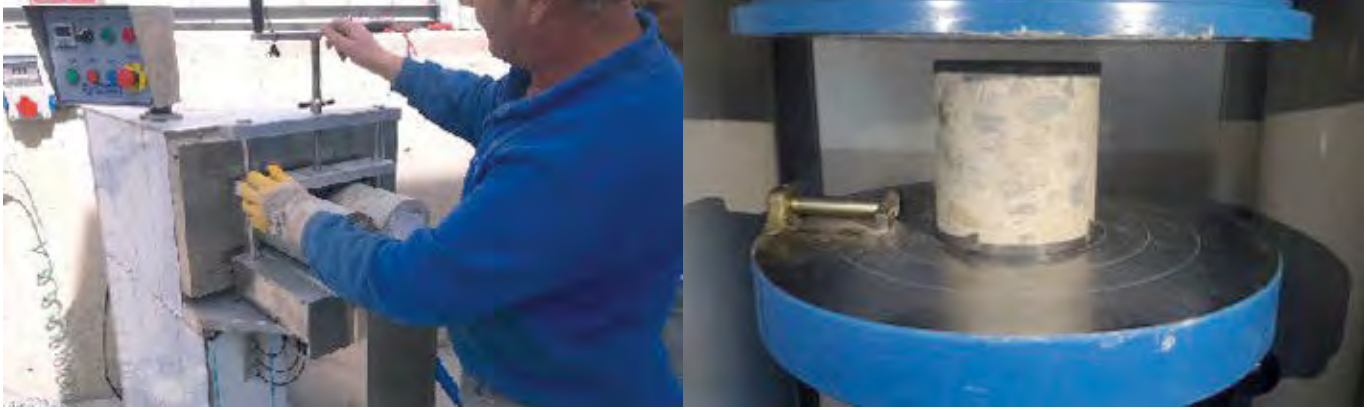
Şekil 4. Karot Numunesi Aşındırma, Başlıklama ve Kırım İşlemi
