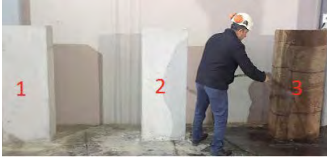
Şekil 2. Laboratuvar Ortamında Modellenen Kolon Elemanları Karot numuneleri, beton 28-Günlük dayanıma geldikten sonra TS EN 12504-1'e [5] göre alınmıştır (Şekil 3). Su soğutmalı, elmas uçlu, 95 mm çapında silindirik bıçaklar hızlı devirde döndürülerek karot alma işlemi gerçekleştirilmiştir.
