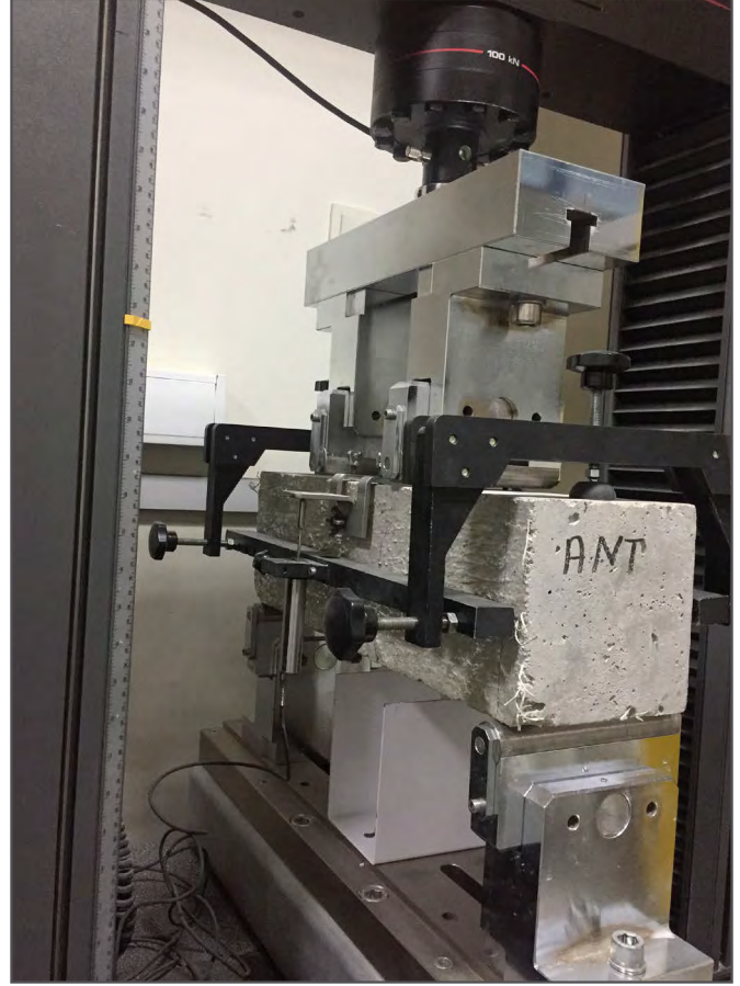
Şekil 3: ASTM C 1609 Test Düzeneği
