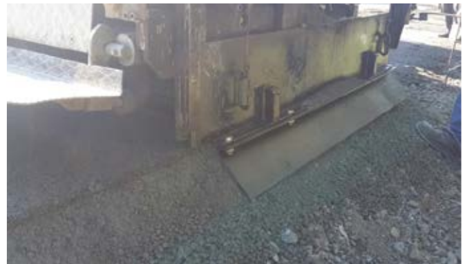
Şekil 9: Kenar plakalarıyla modifiye edilmiş asfalt finişeri
