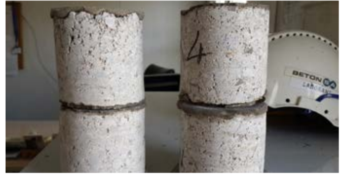
Şekil 12: Beton karot numuneleri
