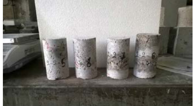
Şekil 1: Sahadan yerinden kesilerek alınan kiriş ve karot numunelerinin bir bölümü
