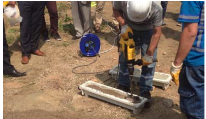
Şekil 2: Vibratörlü çekiçle sıkıştırılan kiriş numuneleri
