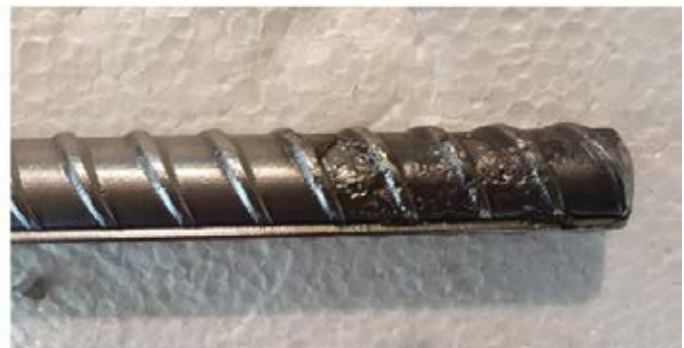
Şekil 9. 350 çevrim sonucu oluşan çatlak ile donatıda oluşan korozyon ve kütle kaybı.
