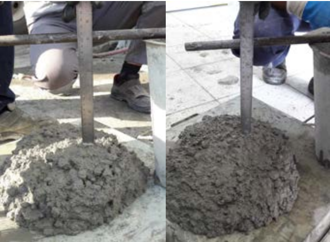
Şekil.4 Çökme Kıvamı Testi
