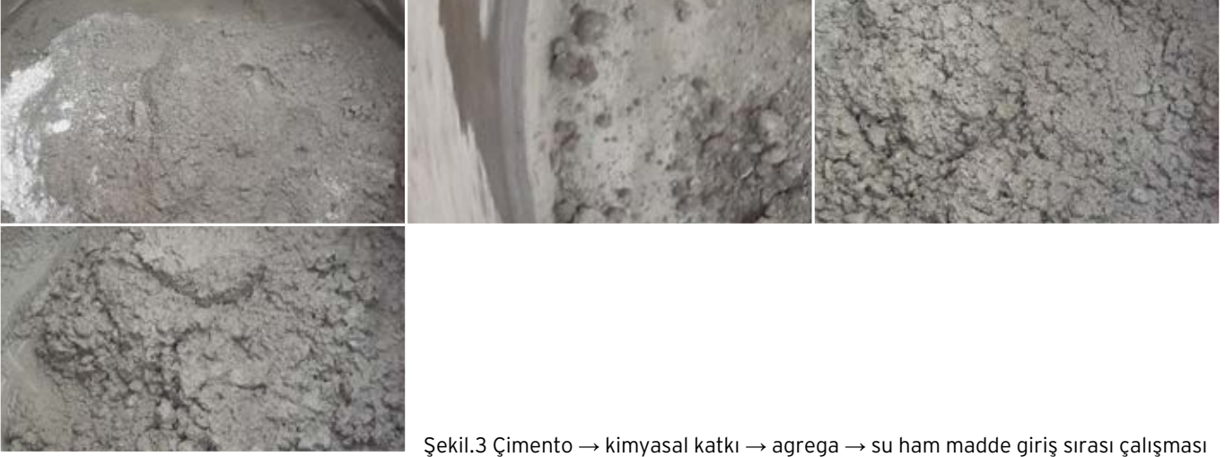
Şekil.3 Çimento → kimyasal katkı → agrega → su ham madde giriş sırası çalışması
