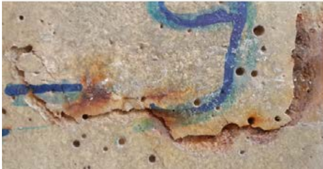
Şekil 9. 350 çevrim sonucu oluşan çatlak ile donatıda oluşan korozyon ve kütle kaybı.
