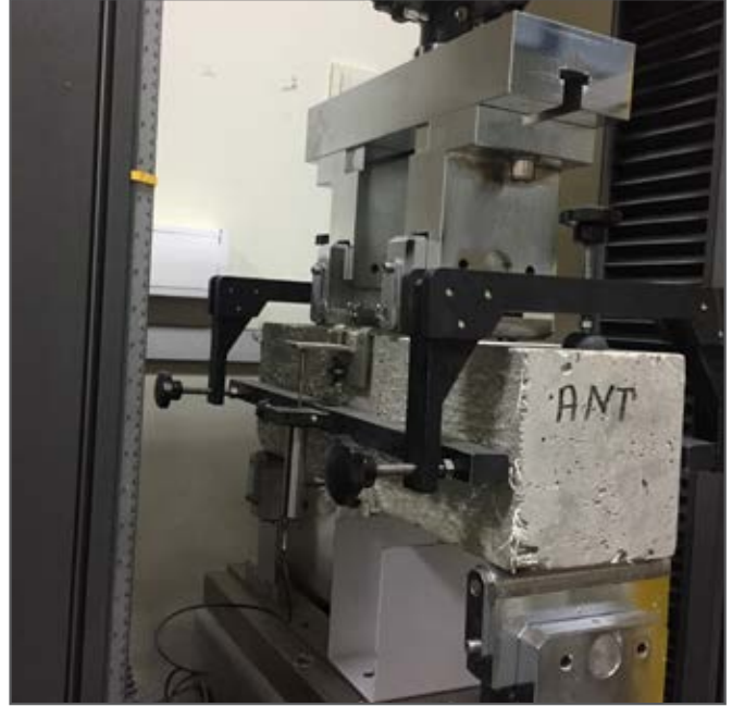
Şekil 3: ASTM C 1609 Test Düzeneği
