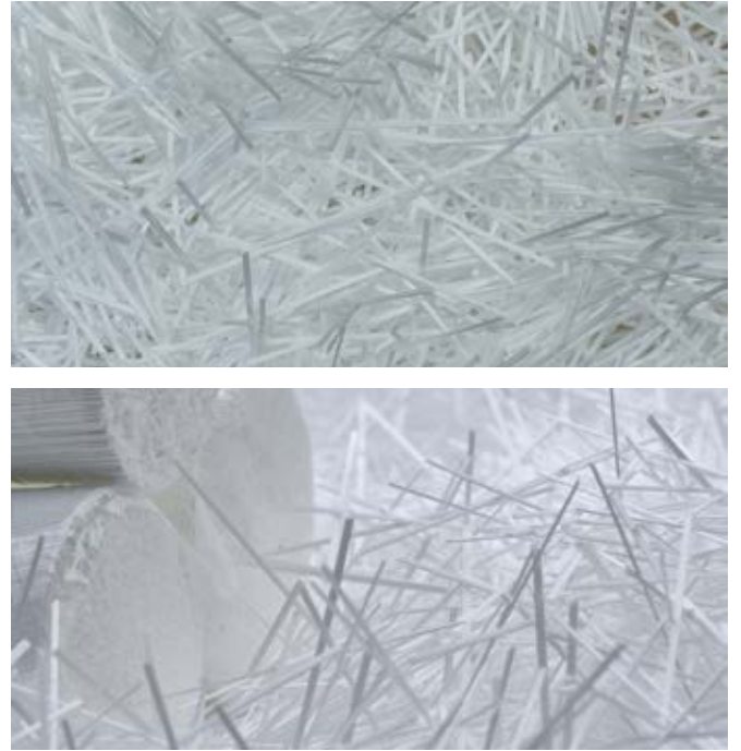
Şekil 1: Makro Sentetik Lif / Makro sentetik fiber donatı
