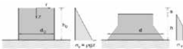
Çökme testi ile akma gerilimini tahmin etmek için formüller
