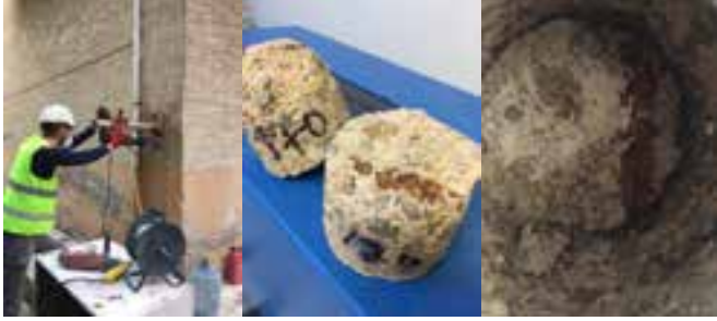
Resim 4: Çoğ düşük dayanım nedeniyle alırken parçalanan numuneler
