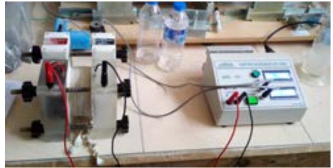
Şekil 2. Hızlı klor geçirirliiliği aparatı ve deney düzeneği
