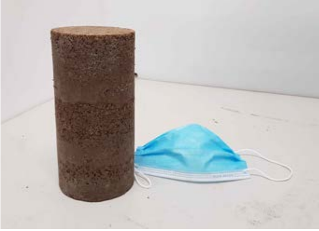
Yüz maskesi atıkları ve işlenmiş bina molozundan elde edilen geri dönüştürülmüş yol yapım malzemesi numunesi.
