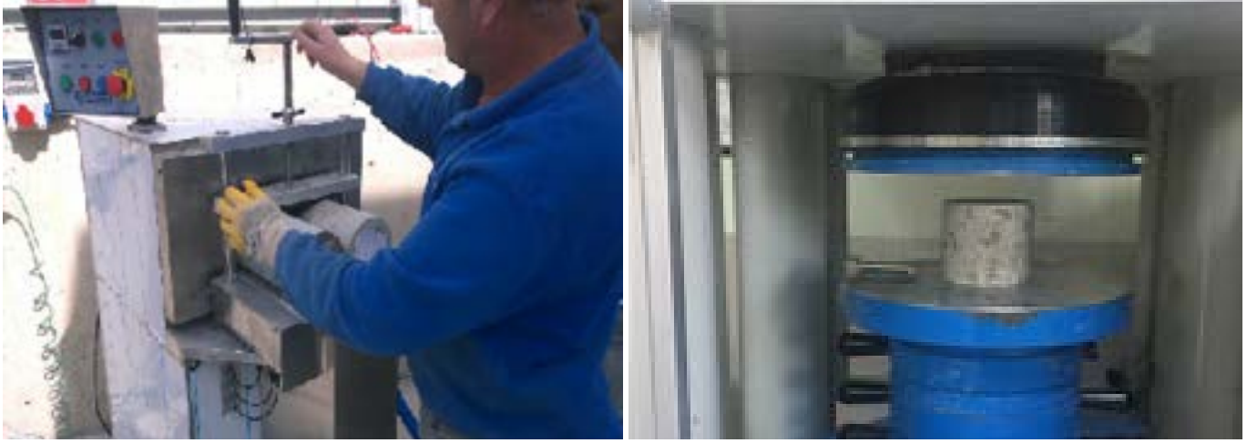
Şekil 4: Karot Numunesi Aşındırma, Başlıklama ve Kırım İşlemi
