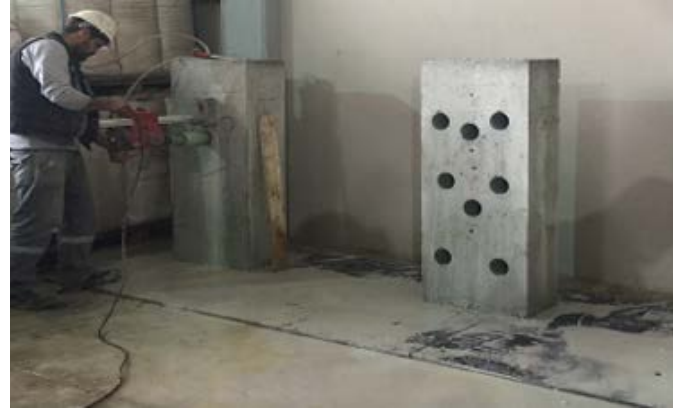
Şekil 3: Kolon Elemanlarından Karot Numunesi Alım İşlemi
