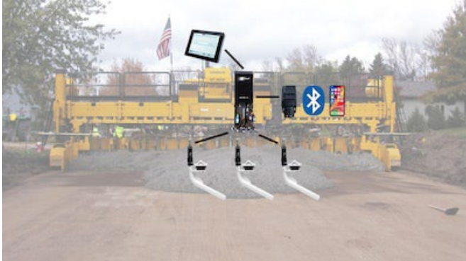
Bluetooth aracılığıyla ayarlanan hızların nasıl seçilebileceğini gösteren bir CFV sistemi
