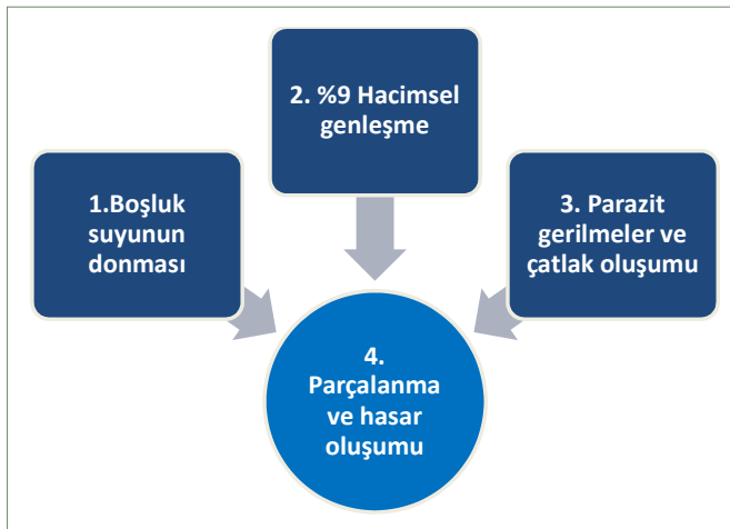
Şekil 4: Donma-çözülmenin sertleşmiş betona etkisi
