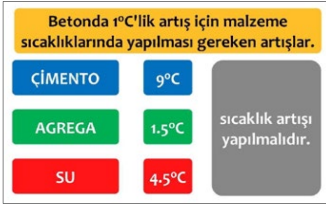
Şekil 6: Ham madde sıcaklık artışının beton sıcaklığına etkisi
