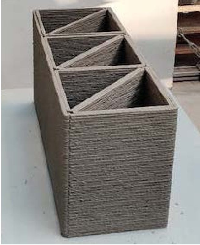
3 boyutlu baskı işlemi kullanılarak yapılan prefabrike bir bina giydirmesi.
