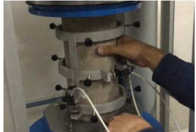
Şekil 1. Beton numunelerin elastisite modülünün ölçüldüğü kompresometre cihazı
