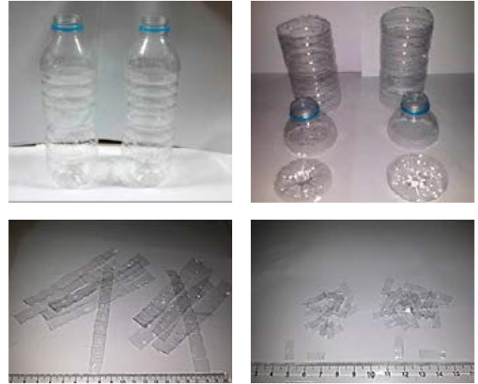
Şekil 2. PET şişe kesme ve lif oluşturma işlemleri
