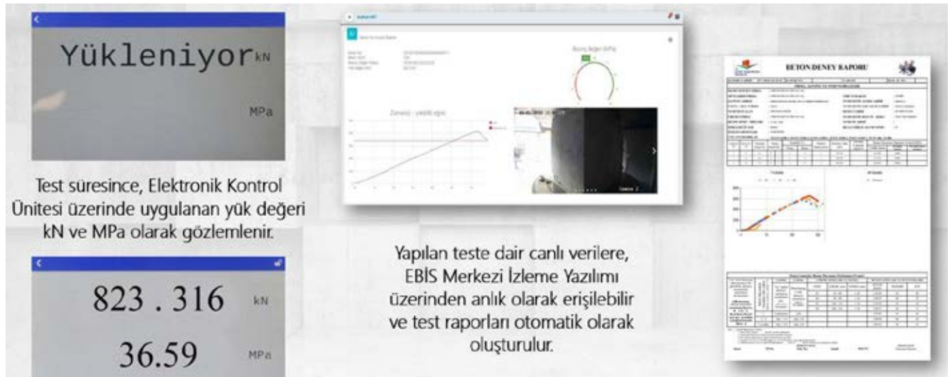
Şekil 16. EBİS test cihazı ekranı, deney raporu ve deney anının eş zamanlı görseli
