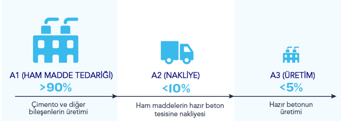
Şekil 63. Hazır betonun beşikten kapıya emisyon aşamaları
