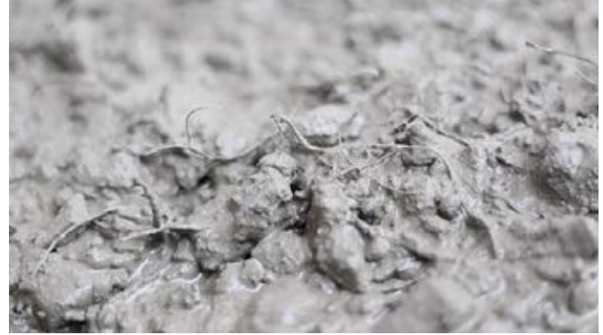
Makrofiber çatlama karşı üç boyutlu güçlendirme sağlar
