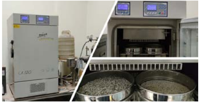
Şekil 1. İYA-esaslı malzemelere uygulanan karbonatlaşma işlemi
