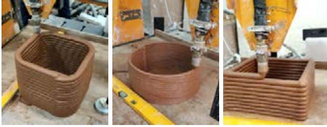
Şekil 2. İYA-esaslı malzemelerin 3B-Eİ ile üretilmesi
