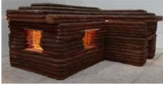
Şekil 2. İYA-esaslı malzemelerin 3B-Eİ ile üretilmesi
