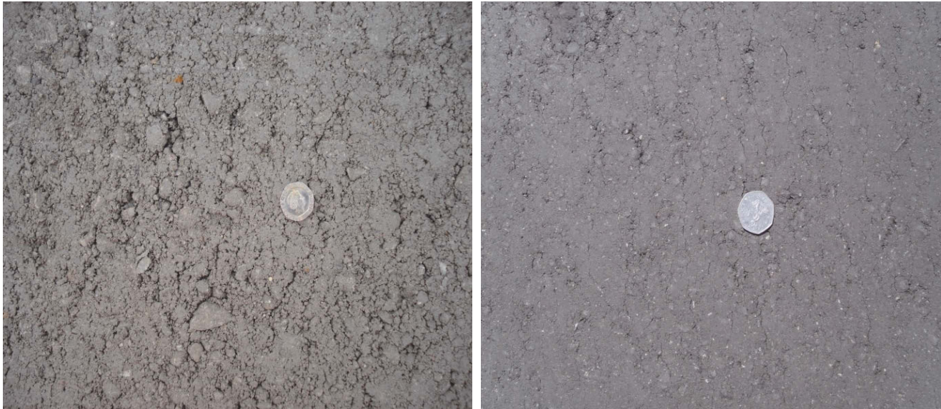
Şekil 1: Tipik yüzey bitirme: D_{max} = 20 \text{ mm} (sol) and D_{max} = 10 \text{ mm} (sağ)
