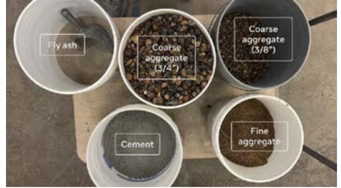
Beton karışımları oluşturmak için kullanılan birkaç temel bileşen, sol üstten saat yönünde: uçucu kül, iri agregalar, ince agrega ve çimento.
