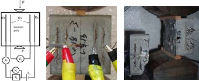
Şekil 3. Yarmada çekme deneyi: (a) devre şeması, (b) testteki numune, (c) test sonrası numune
