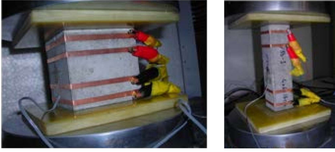
Şekil 5. Çevresel elektrotlarla basınç deneyi: (a) kübik numune ve (b) prizmatik numune
