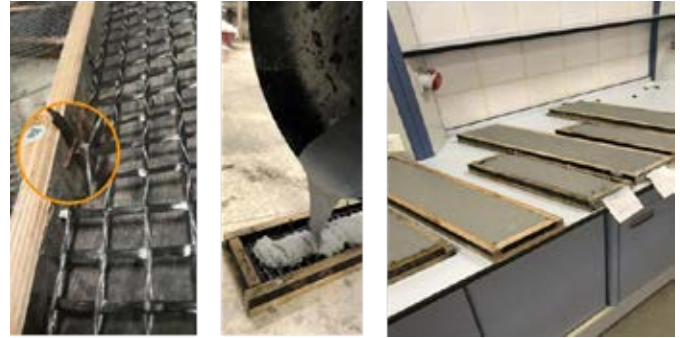
Şekil 4. M120 matrisi ile kompozitlerin üretim aşamaları
