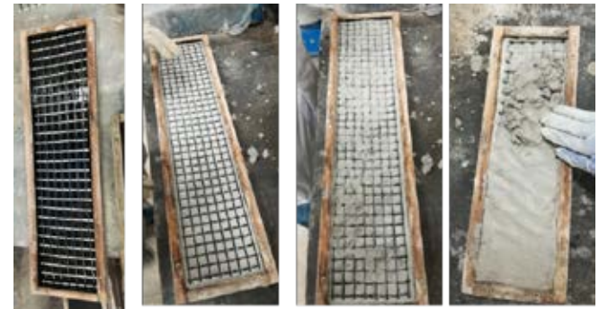
Şekil 5. M60 matrisi ile kompozitlerin üretim aşamaları
