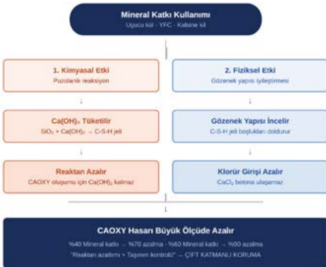
Şekil 10. Mineral katkı kullanımının çift etkili koruma mekanizması Mineral katkının türü, CAOXY azaltımındaki etkinliği doğru- dan belirlemektedir. Uçucu kül ve yüksek fırın cürufu (YFC) gibi puzolanik katkıları %40 ikame oranında CAOXY mikta- rını OPC referansına kıyasla yaklaşık %70, %60 ikamede ise
