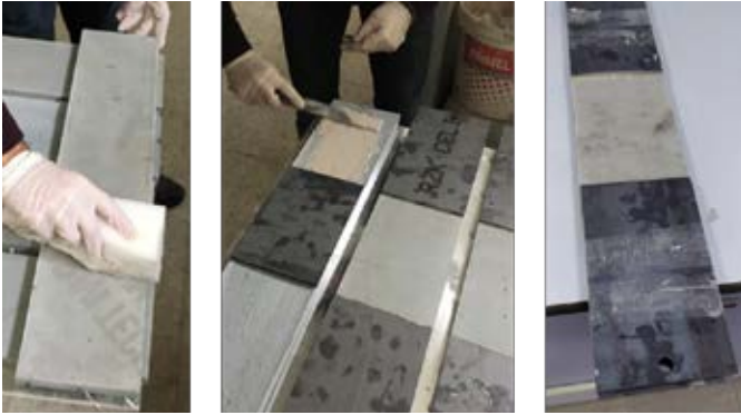
Şekil 6. Çekme deneyi için çelik aparatların yapıştırılma aşaması
