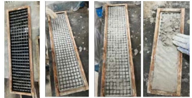
Şekil 5. M60 matrisi ile kompozitlerin üretim aşamaları
